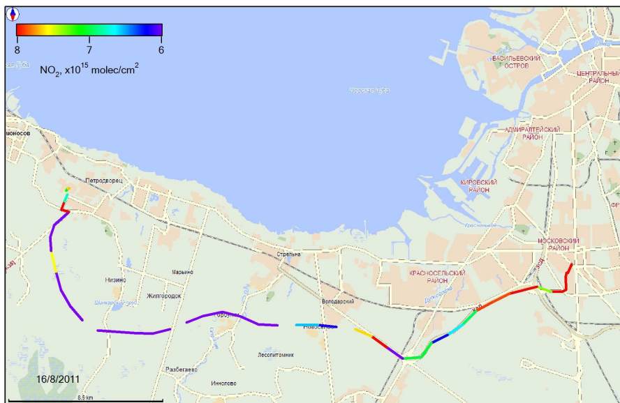
Мобильные спектроскопические измерения содержания тропосферного \text{NO}_2 в Санкт-Петербурге
