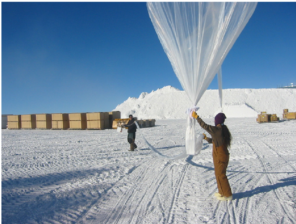
Рис. 8. Подготовка к запуску озонозонда над Антарктидой.
