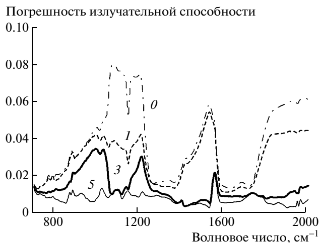
Рис. 2. Погрешность оптимального параметрического представления излучательной способности \varepsilon(\nu) при использовании базиса ЭОФ различной размерности. Указана размерность базиса, 0 – априорная погрешность.
